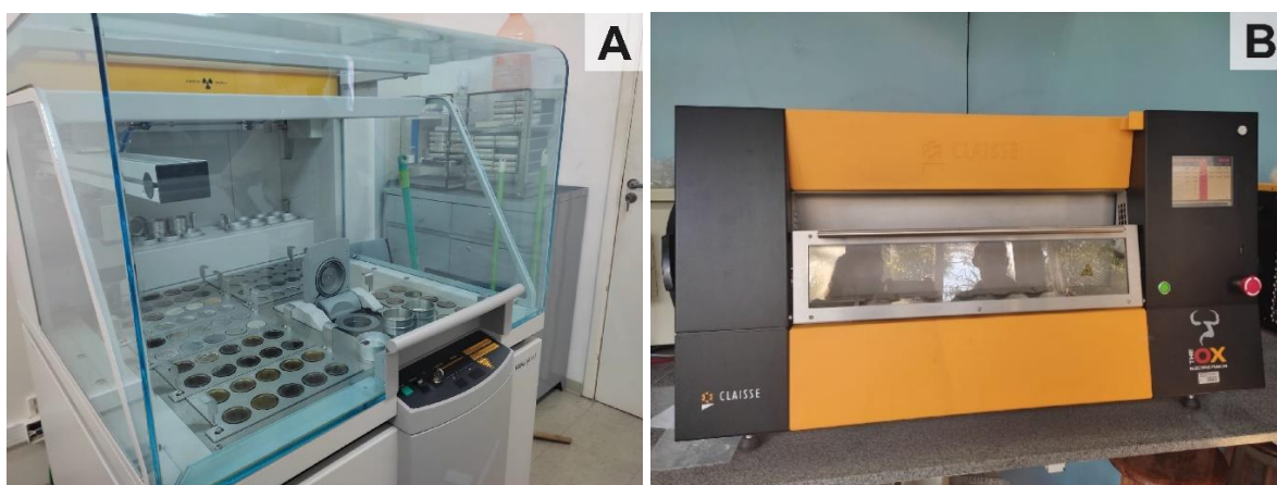
Fig. 5.1. A: espectrômetro de fluorescência de raios X – PANalytical modelo AXIOS MAX Advanced, patrimônio da USP; B: máquina de fusão elétrica Claisse – TheOX, patrimônio da USP. Fonte: acervo pessoal.
